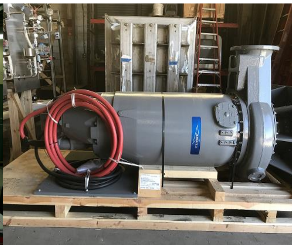
New Flygt Pumps (6 pumps)
